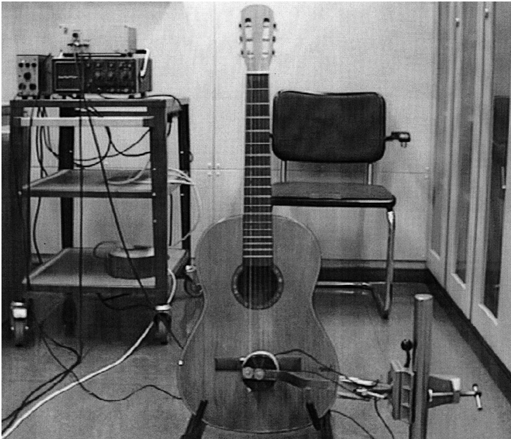
Fig. 40. Positionierung der Gitarre im Gitarrenständer zur Messung der Schwingungen der Decke und des Halses.
